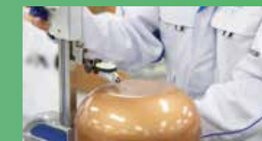
部品/製品抜き取り検査(写真は寸法検査)
